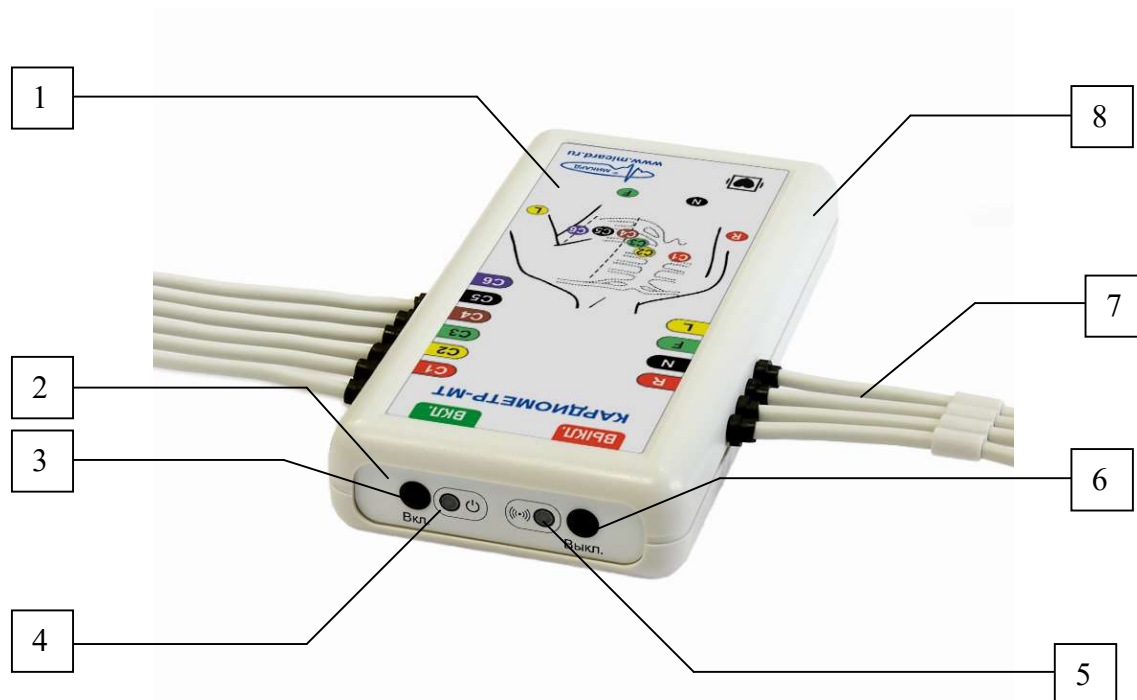
Рисунок 3.3 – Кардиометр. Вид сверху: 1 – лицевая наклейка; 2 – торцевая наклейка; 3 – кнопка включения питания; 4 – индикатор включения питания; 5 – индикатор наличия связи по Bluetooth; 6 – кнопка выключения питания; 7 – кабель отведений; 8 – основной блок
